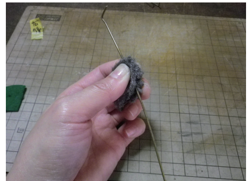
図16 スチールウールで金属を磨く Fig. 16 Metal parts are polished with steel wool
